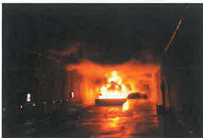
Bild 6 Flüssigkeitsbrand ca. 20 Sekunden nach Entzündung Pool fire approx. 20 seconds after ignition
