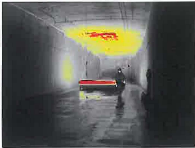
Bild 13 Aufnahmen mit Wärmebildkamera kurz nach Versuchsende (100 MW Flüssigkeitsbrand und 100 MW Feststoffbrand, jeweils mit Einsatz von Wassernebel) Recordings by thermal imaging camera shortly after the end of the tests (100 MW pool fire and 100 MW solid matter fire, both with activation of water mist)
