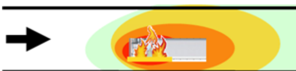
Abb. 6: Schematische Darstellung des Bereichs mit hohen Temperaturen bei einem LKW Brand mit aktivierter BBA
