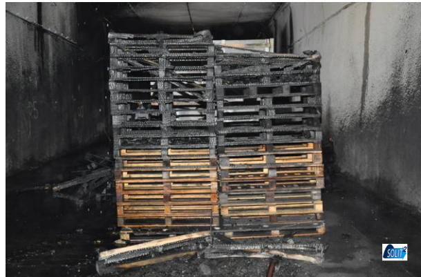
Abb. 16: Brandausbreitung auf ein weiteres Objekt im Abstand von 5 m bei einem Brandversuch ohne BBA
