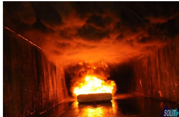
Abb. 20: Rauchschiebung bei einem 30 MW Flüssigkeitsbrand kurz nach der Zündung auch entgegen der Strömungsrichtung.
