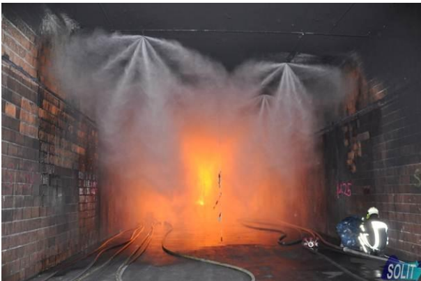
Abb. 19: Störung der Rauchschiebung bei aktivierter BBA bei einem vergleichbaren Brand wie Abb. 20
