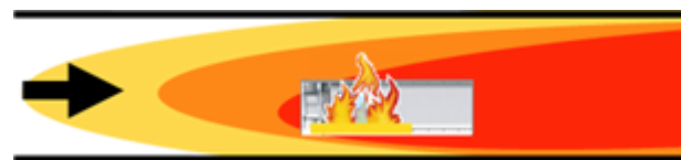
Abb. 7: Schematische Darstellung des Bereiches mit sehr hohen Temperaturen bei einem LKW Freibrand
